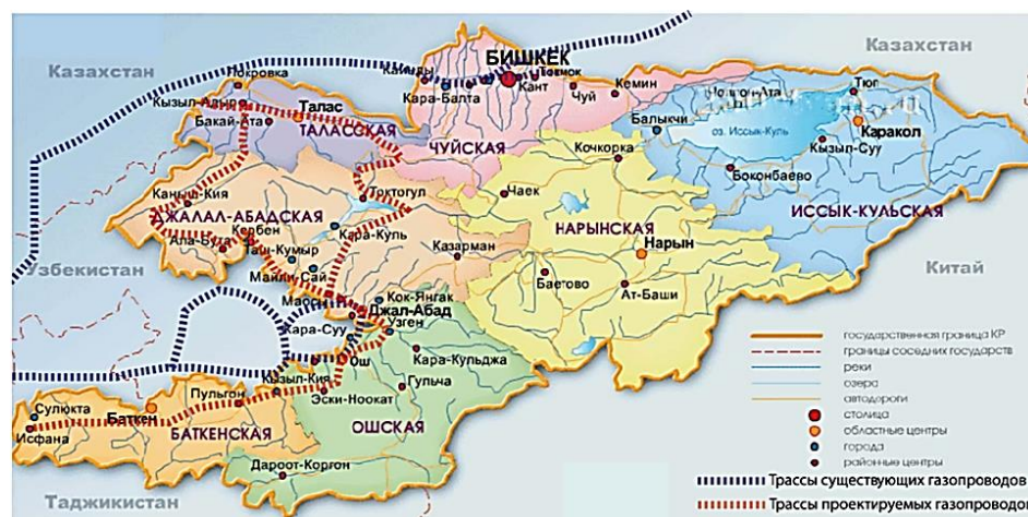
Рисунок 1 – Схема газопроводов Кыргызской Республики
